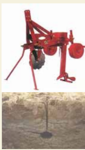
振動式弾丸暗渠機 30馬力程度の中型トラクタでも暗渠が施工でき、振動によって耕盤破砕を容易にし、かつ亀裂が入りやすくなる効果がある。
