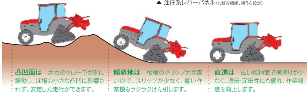
**凸凹面は** 左右のクローラが別々に揺動し、ほ場の小さな凸凹に影響されず、安定した走行ができます。
