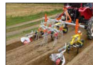
※写真はS3カルチ3条+ウルトラQ2条 +3点ヒッチ+平高用金具2個+アゴロ増土器2個
