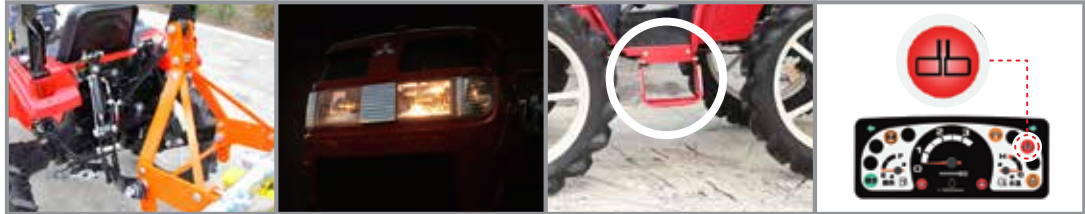
3点リンク標準装備 コーナーライト 運転席左側昇降ステップ ブレーキ連結忘れ警告ランプ
