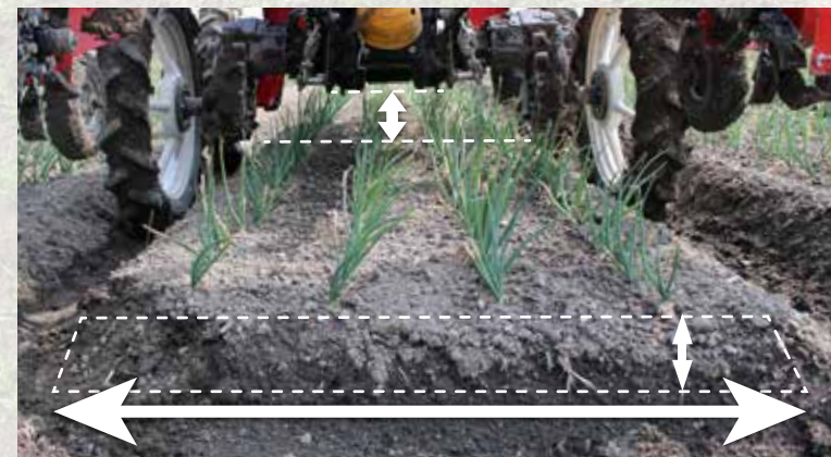
参考写真：うね高さ 150mm うねすそ幅 1,200mm うね天からミッションケースまでの距離 270mm
