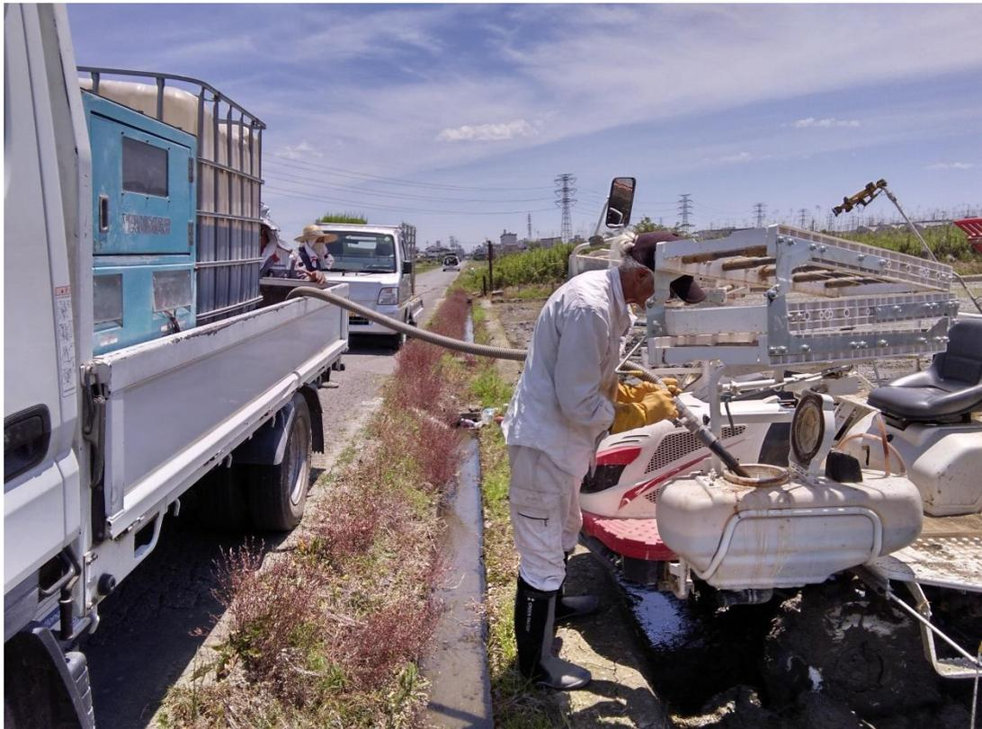
ペーストチャージャーで軽トラから直接肥料補給している様子
