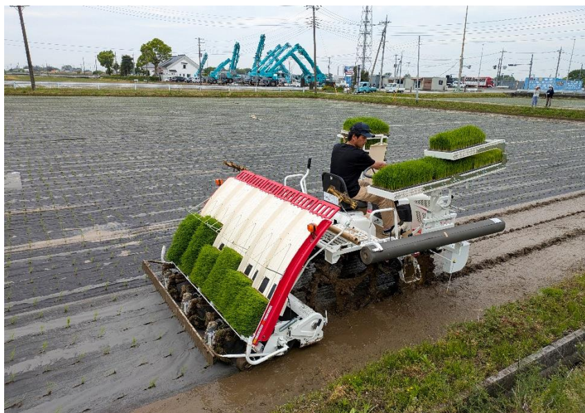
活性炭を配合した紙ロールの長さは一本 170m で、約 45 日間雑草の発生を抑える
